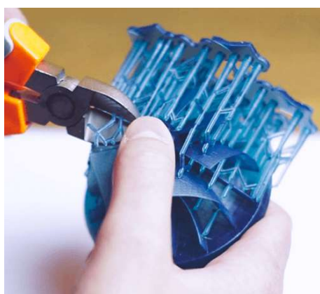
Figura 2.5 Exemple d'un post processa d'eliminació de suports
