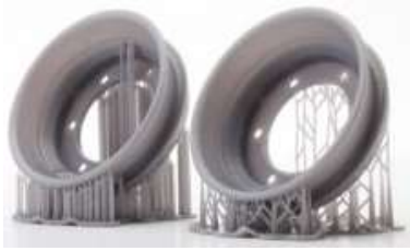
Figura 2.3 Exemple d'una peça curada i d'una de curada.
