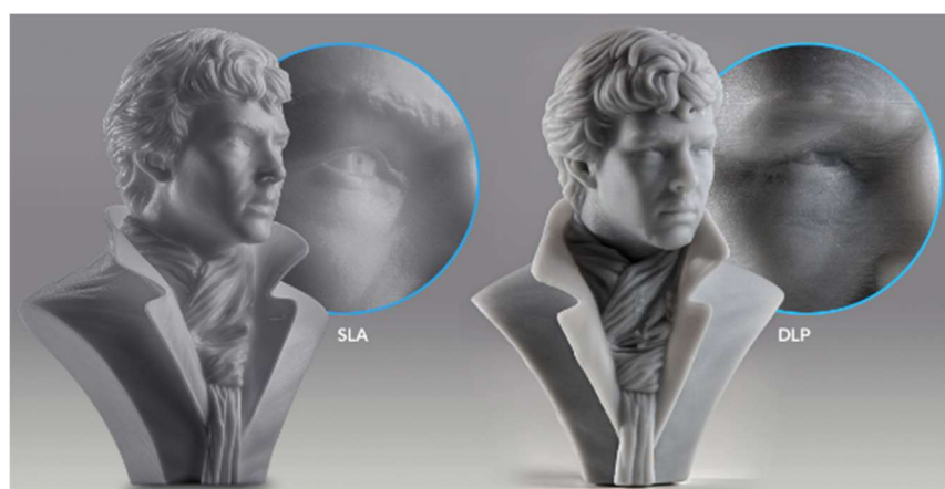
Figura 2.7 Diferència de resolució entre imprimir una mateixa peça en SLA i DLP
