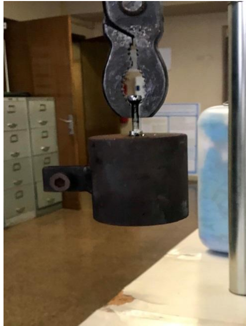
Figura 21. Cargol que suporta una peça de 800 g enganxat amb una formulació intermèdia de TGAPJEFDDS1_0,1_0,9 que actua com adhesiu
