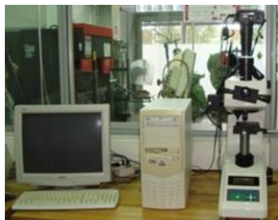
Figura 19. Microindentador MicroKnoop 401MAV de Wilson Wolpert utilitzat per mesurar la microduresa
