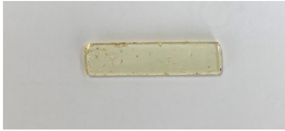
Figura 22. Proveta del material intermedi de la formulació TGAPJEFDDS1_0,75_0,25
