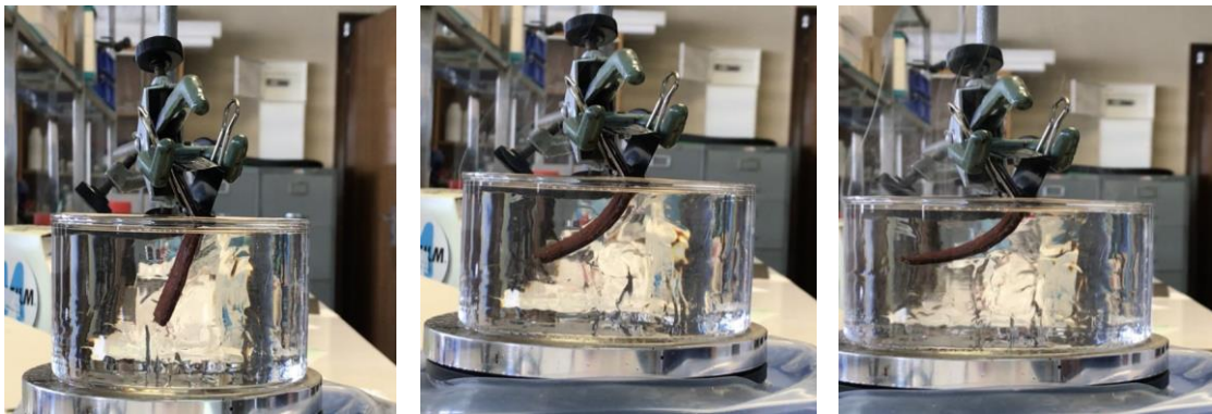
Figura 26. Recuperació de la forma permanent en un interval de temps de la formulació TGAPJEFDDS1_0,75_0,25.
