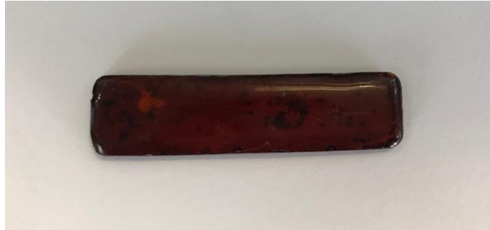
Figura 25. Proveta del material final amb la seva forma temporal de la formulació TGAPJEFDDS1_0,75_0,25
