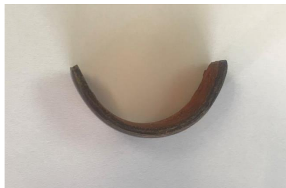
Figura 24. Proveta del material final amb la seva forma permanent de la formulació TGAPJEFDDS1_0,75_0,25
