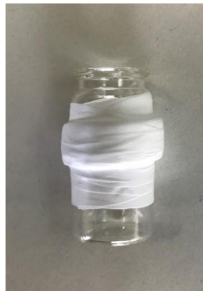
Figura 23. Vial de vidre on es subjecta la proveta de TGAPJEFDDS1_0,75_0,25
