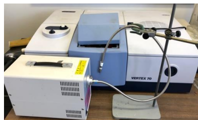
Figura 7. Espectrofotòmetre d'infrarojos per transformada de Fourier
