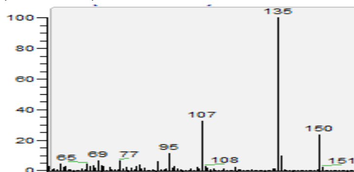
Figura 27: Espectre de masses del Hexadecanoat d'isopropil. Font: Xcalibur
