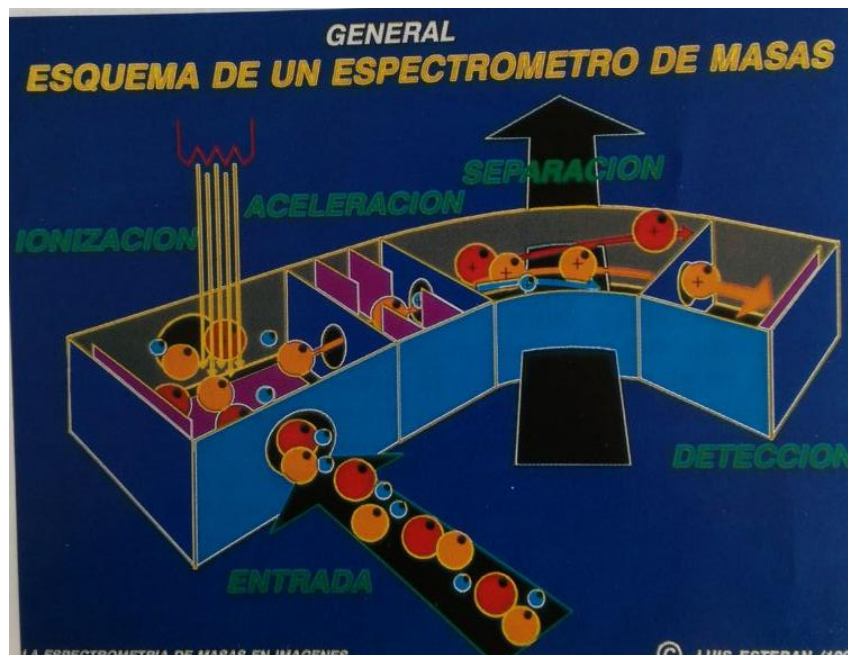
Figura 6: Esquema de les etapes d'un espectròmetre de masses. Font: Esteban, L. (1993). La Espectrometria de masas en imagenes . ACK Editores.
