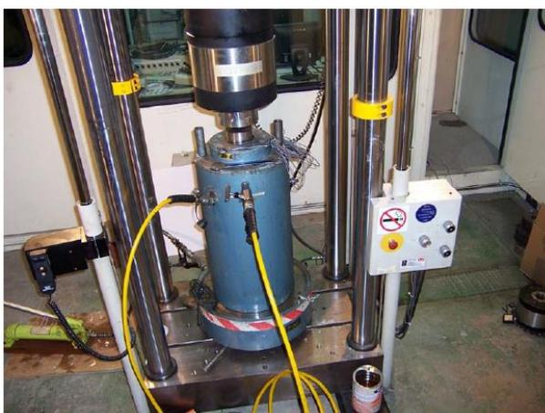
Figura 3.8. Cámara triaxial utilizada en el ensayo.
