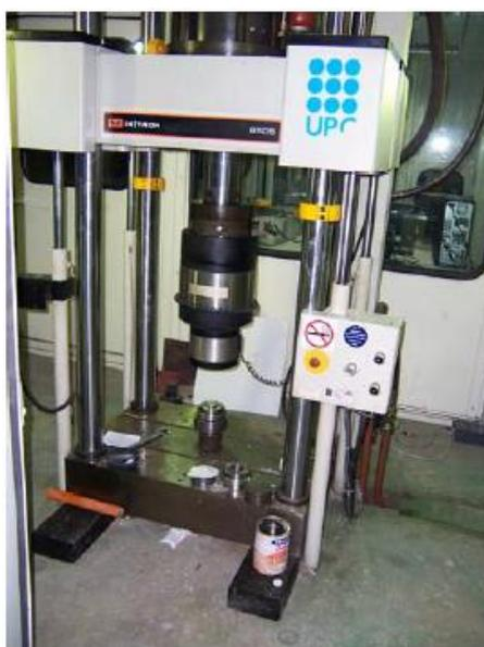
Figura 3.7. Prensa hidráulica utilizada en los ensayos.
