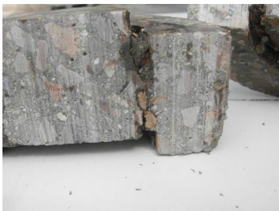
Figura 5.4. Plano de fractura en un ensayo confinado en el que se aprecian áridos desplazados que han sido cortados en dos piezas por una fisura aproximadamente recta.
