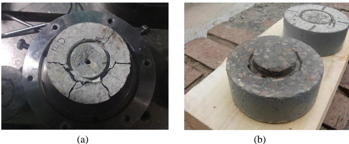
Figura 5.3. a) Estado de la muestra después del ensayo sin confinamiento con grandes fisuras radiales completamente desarrolladas; b) fisuras circunferenciales con desplazamiento vertical del núcleo (sin fisuras radiales) en una muestra ensayada bajo un confinamiento de 8 MPa.
