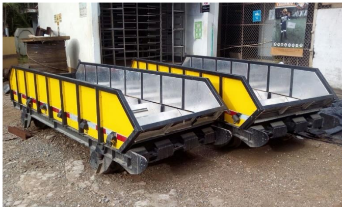
Ilustración 5. Skips de personal utilizados para las elevadoras 3620 y 3860 en bocamina antes de su instalación
