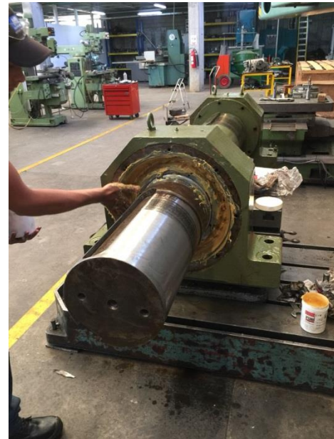
b) Proceso de lubricación de los rodamientos en la chumacera
