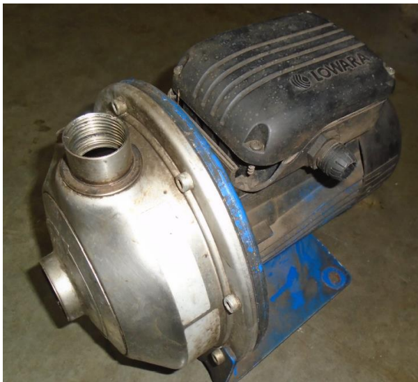
Figura 9. Bomba antigua del sistema de aspersión.
