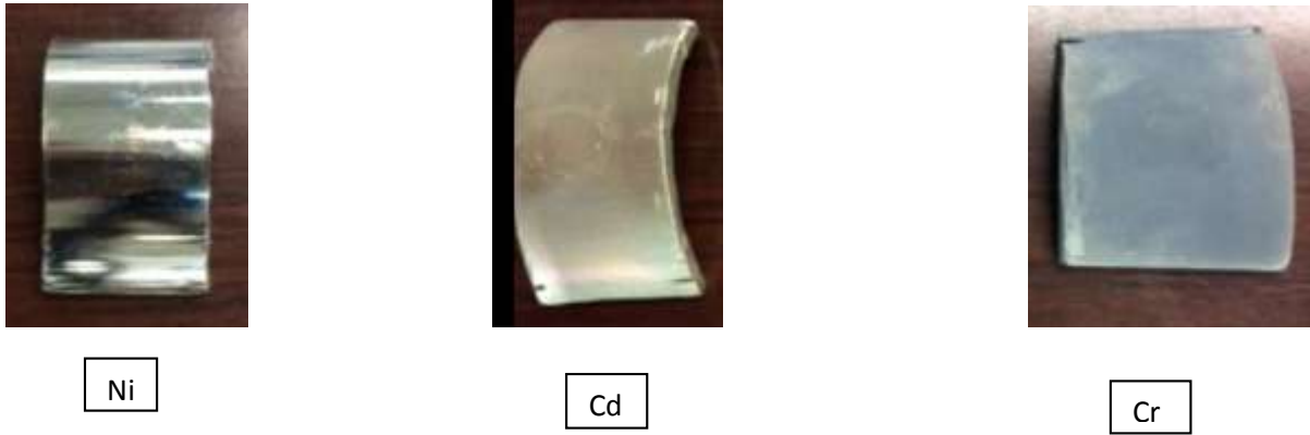
Figura 5. Probetas de acero AISI 4130 recubiertas con Cromo, Níquel y Cadmio
