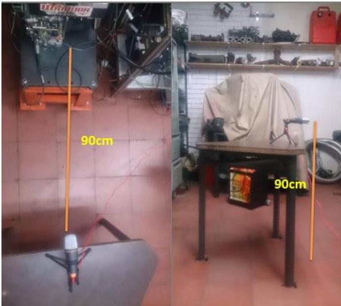
Significa entonces que ya tenidas todas las instalaciones de los instrumentos de medida faltaba la preparación del motor para la toma de todos los datos. El procedimiento que es mencionado a continuación, se realiza para todas las réplicas del experimento y consiste en que inicialmente, se enciende y calienta el motor por un tiempo, luego se ajusta la velocidad
