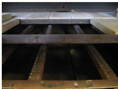
Figura 3.2 - (a) Detalhe dos queimadores originais do forno (b) Lastro de tijolos refratários
