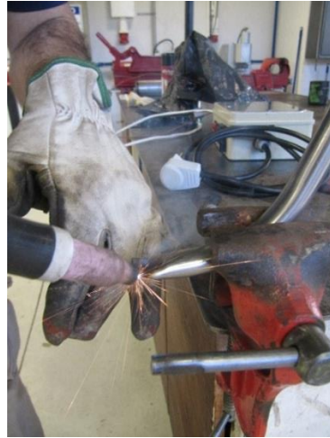
Figura 3.12 - (a) Detalhe do esmagamento obtido (b) corte do excesso de material com a máquina de soldar TIG ( tugstein inert gas )
