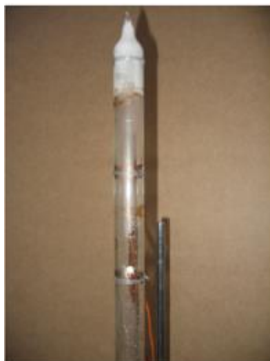
Figura 2.13 - Naftaleno recristalizado na região superior do condensador [10]
