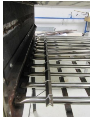
Figura 3.13 - (a) Nivelamento dos termosifões (b) detalhe da barra em L utilizada para o nivelamento dos tubos
