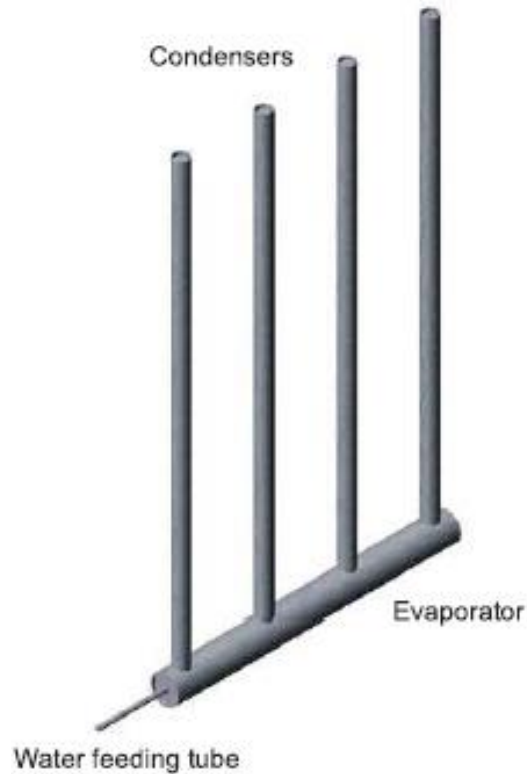
Figura 2.5 - Esquema da configuração de termossifões em árvore [9]
