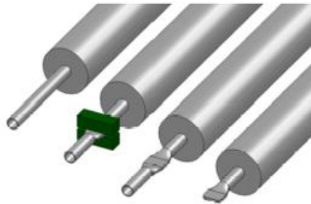
Figura 3.16 - Etapas do procedimento de selagem do tubo [1]
