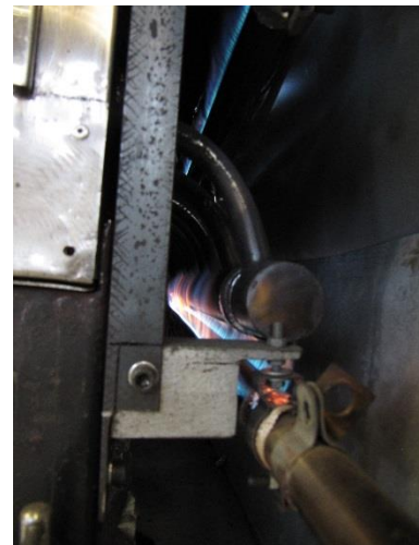
Figura 4.12 - Detalhe dos queimadores em operação a alta potência (a) originais (b) na câmara de combustão
