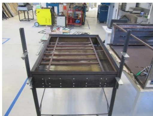
Figura 3.4 - (a) Rasgos na chapa lateral onde entram os termossifões (b) Estrutura construída para suportar as árvores e os queimadores
