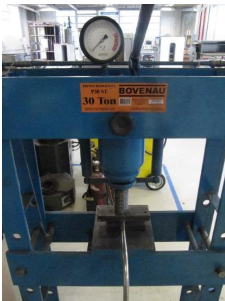
Figura 3.11 - (a) esmagamento da ponta dos condensadores com a prensa hidráulica (b) Carga aplicada na prensa hidráulica
