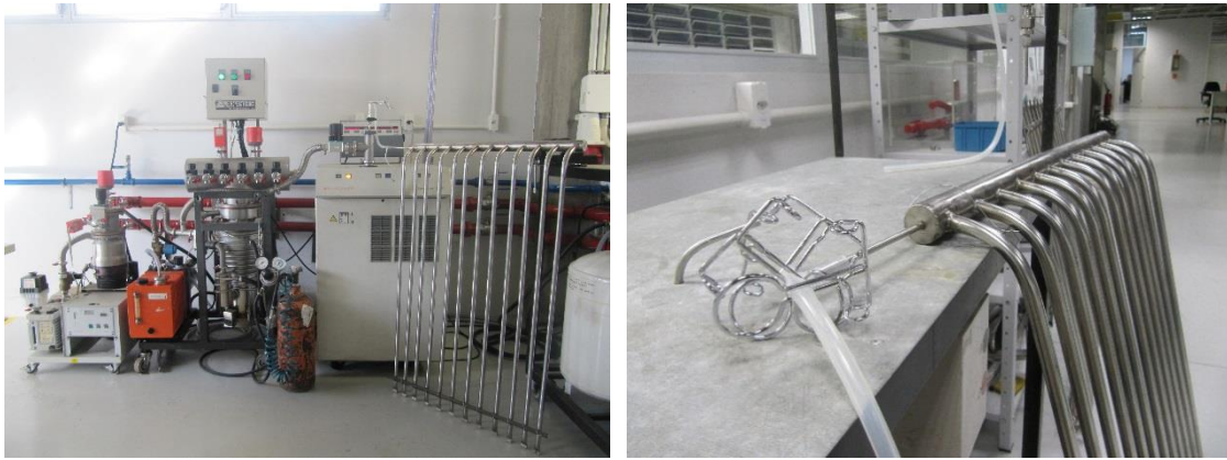
Figura 3.15 - (a) Equipamento para detetar vazamentos (Leak Detector Spectron 5000 Edwards ©) (b) Detalhe do tubo umbilical ligado ao tubo de sucção do equipamento
