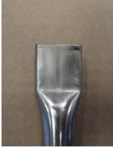
Figura 3.12 - (a) Detalhe do esmagamento obtido (b) corte do excesso de material com a máquina de soldar TIG ( tugstein inert gas )
