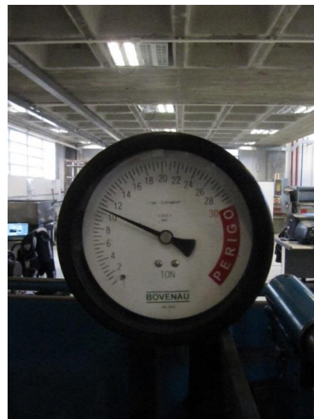
Figura 3.11 - (a) esmagamento da ponta dos condensadores com a prensa hidráulica (b) Carga aplicada na prensa hidráulica
