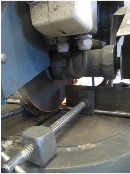
Figura 3.10 - (a) corte dos tubos (b) calandragem dos tubos condensadores
