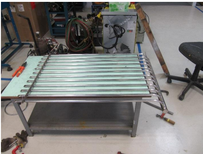
Figura 3.13 - (a) Nivelamento dos termosifões (b) detalhe da barra em L utilizada para o nivelamento dos tubos
