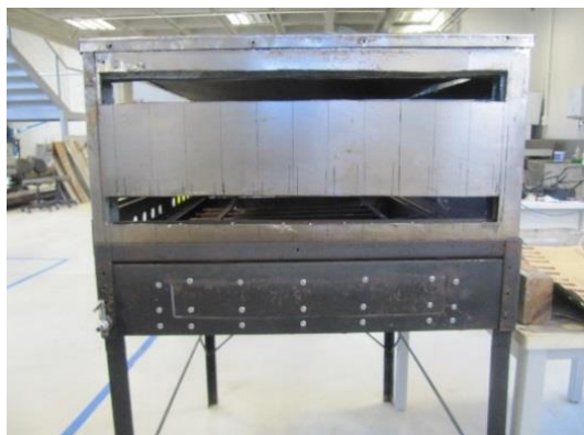
Figura 3.4 - (a) Rasgos na chapa lateral onde entram os termossifões (b) Estrutura construída para suportar as árvores e os queimadores
