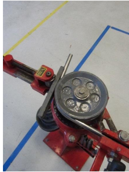
Figura 3.10 - (a) corte dos tubos (b) calandragem dos tubos condensadores
