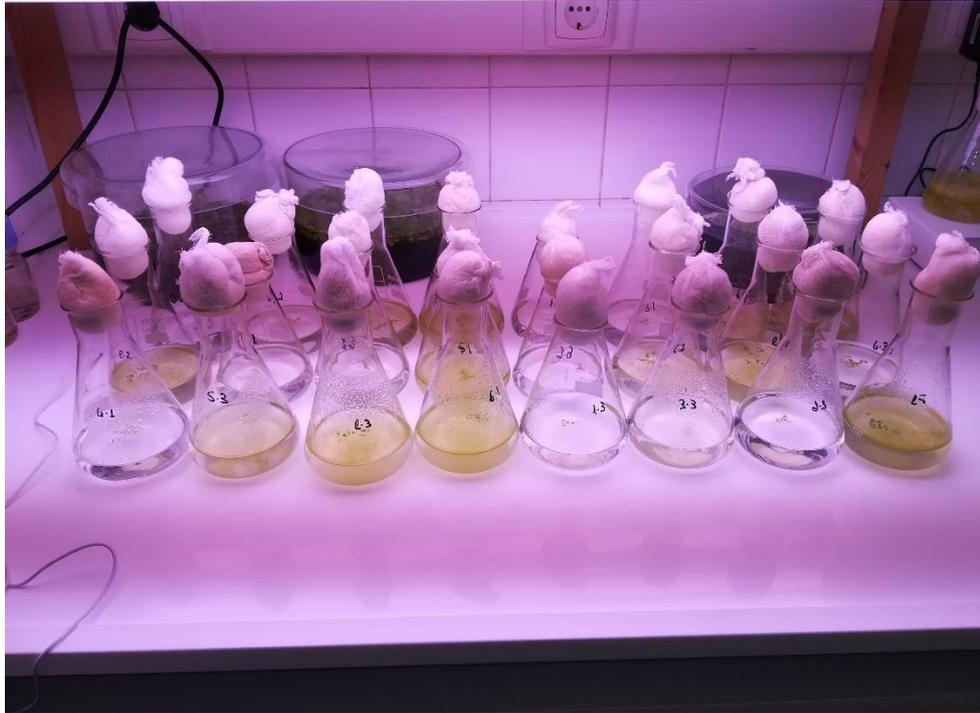
Figura 4.8- Fim do teste de referência com dicromato de potássio
