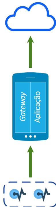
Figura 1.2: Transmissão dos dados dos sensores para a *Cloud* através do *smartphone*.
