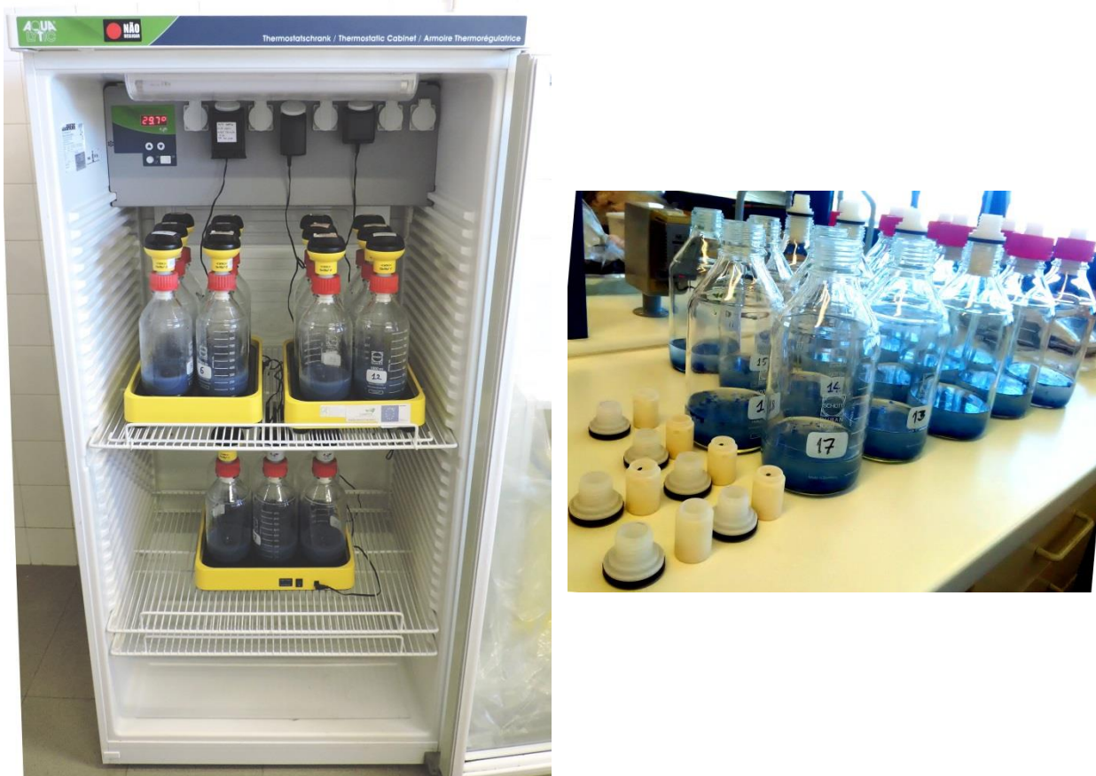
Figura 4.3-3: Montagem de um ensaio OxiTop®. À esquerda: câmara de incubação com reactores no início do ensaio (t=5h). À direita: montagem do ensaio, reactores e reservatórios de NaOH.
