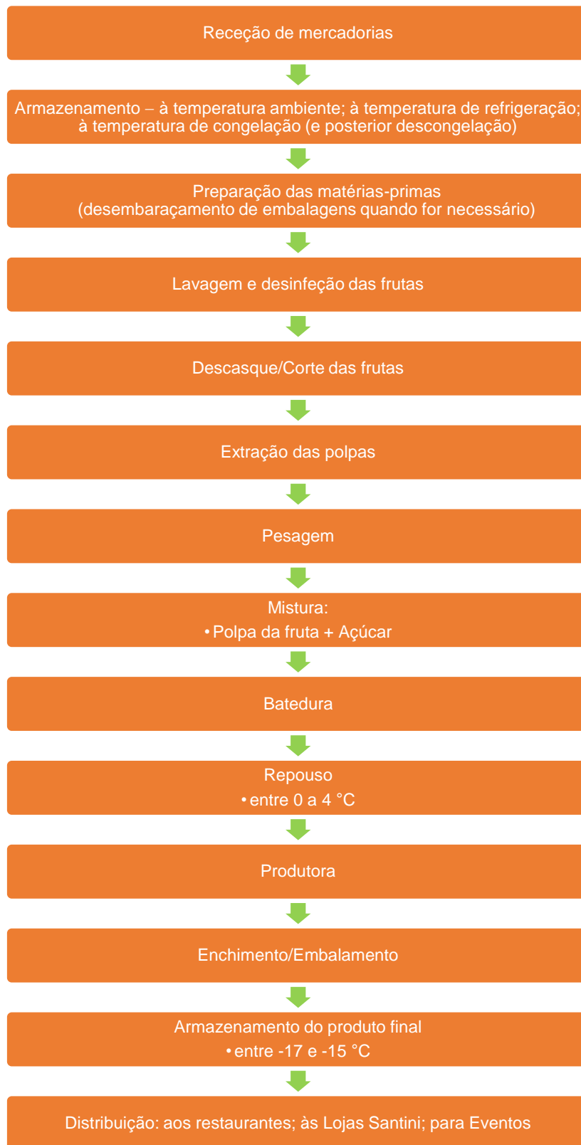
Figura 1.6 - Fluxograma de produção, adaptado, dos sorbets de manga e de limão da Santini. Fonte: Santini.
