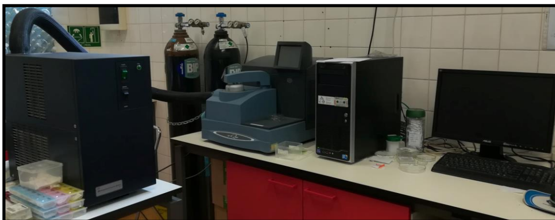
Figura 3.1 - Aparelho de Calorimetria Diferencial de Varrimento (DSC) Q2000 da TA Instruments , utilizado para traçar o perfil térmico dos gelados de base de nata e dos sorbets de manga e limão.
