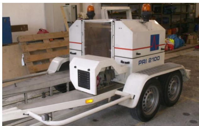
Figura 2.9 - Ensaio de carga com Defletómetro de Impacto (Grontmij, 2011; Pereira, 2014).
