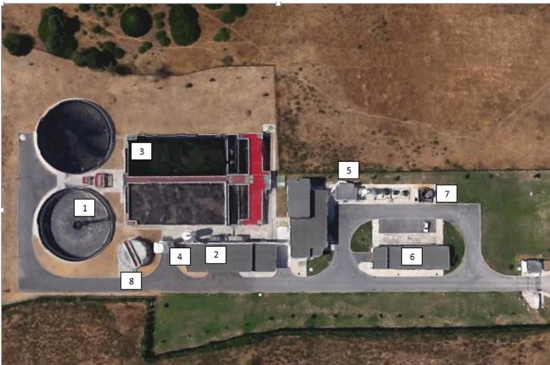
**Figura 2.1** -Extrato de ortofotomapa: ETAR de Boavista Adaptado de: Google Earth 2015. 1-Decantador secundário; 2-Edifício de apoio; 3-Reactores Biológicos; 4-Silo de lamas; 5-Instalações de desodorização; 6- Edifício de Exploração; 7-Reservatório de Sulfato de Ferro; 8-Espessador gravítico
