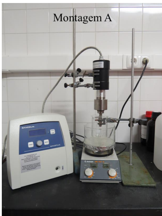
Figura 2.2 – Montagens A e B das reações entre a sodalite de enxofre \text{Na}_8[\text{SiAlO}_4]_6\text{S}_{0,3}\text{Cl}_{1,4} e nitrato de prata.
