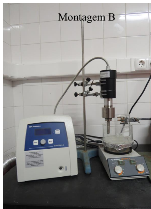
Figura 2.2 – Montagens A e B das reações entre a sodalite de enxofre \text{Na}_8[\text{SiAlO}_4]_6\text{S}_{0,3}\text{Cl}_{1,4} e nitrato de prata.
