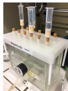
Figura 3.3 - Extração do efluente por SPE
