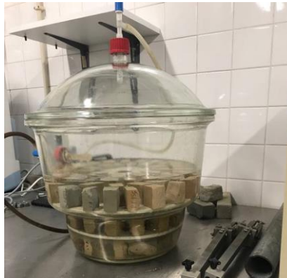
Figura 5.11 – Amostras de provete de calda inseridas no exsicador
