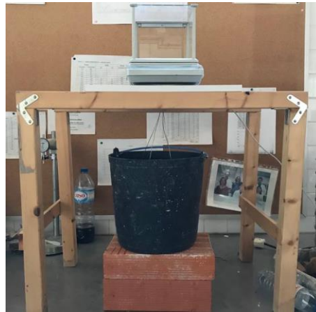
Figura 5.12 - Pesagem hidrostática dos provetes de calda
