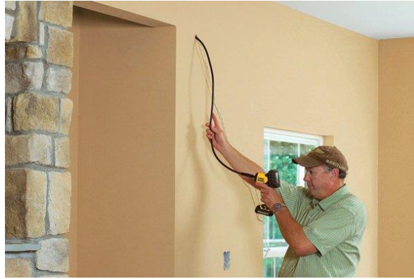
Figura 2.14 - Ensaio com boroscópio [18]
