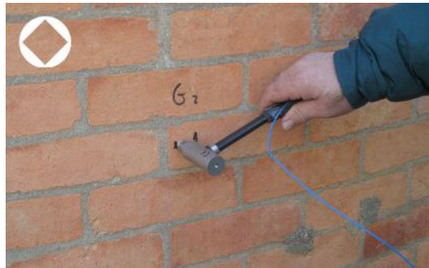
Figura 2.11 - Martelo para ensaio sónico [15]
