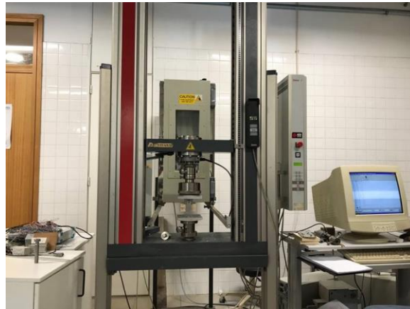
Figura 5.8 - Prensa dos ensaios de flexão e compressão
