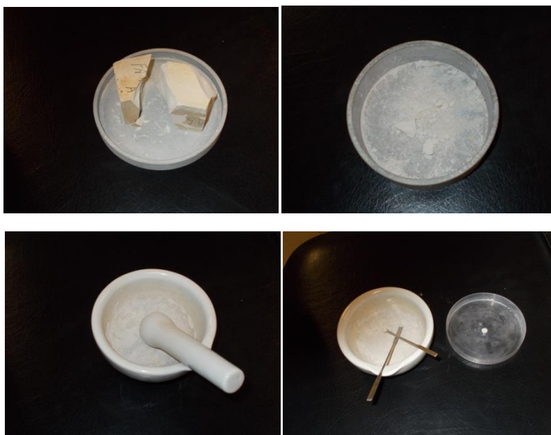
Figura 5.13 - Várias fases da amostra durante a picagem e moagem para o ensaio de termogravimetria
