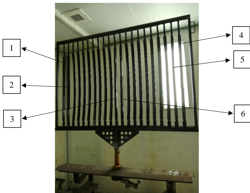
Figura 3.17 - Jig no qual foi efetuado o processo de pintura posterior aos testes de simulação do processo de pré-tratamento.
