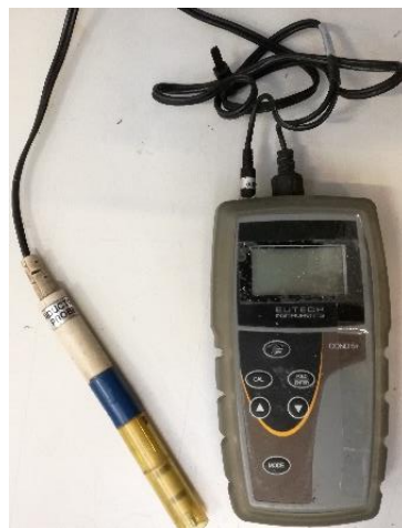
Figura 3.4 - Medidor de Condutividade Crison Cond6+
