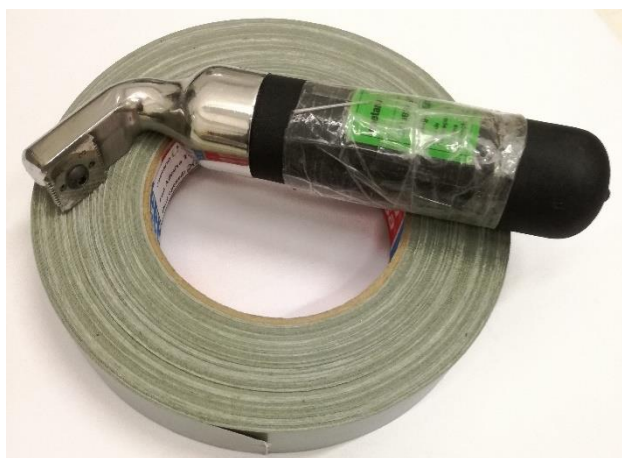
Figura 3.10 - Cortante Elcometer 155 com lâmina de 11 dentes com 1mm de espaçamento e Fita Tesa 4657 utilizados para o ensaio de aderência do projeto M161.
