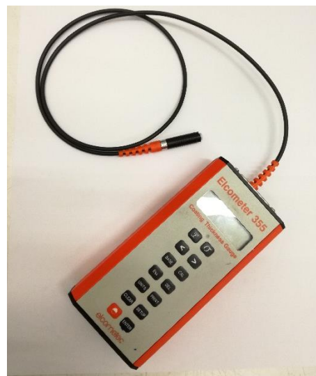
Figura 3.9 - Medidor de espessuras (Coating Thickness Gauge Elcometer® modelo 355) com uma sonda para alumínio (Elcometer® com o modelo T35511982)
