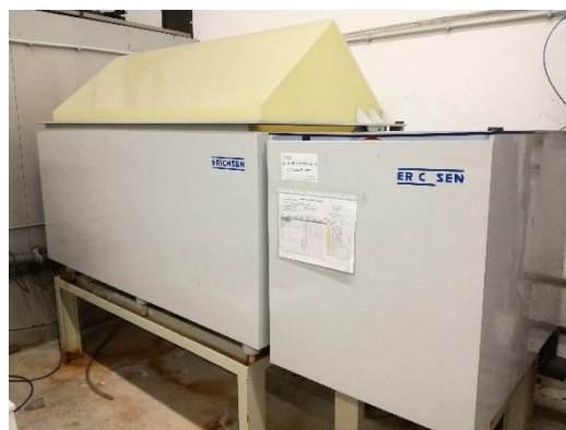
Figura 3.13 - Câmara de Nevoeiro Salino Erichsen 606/1000
