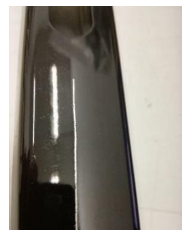
Figura 3.14 - Exemplo de corte aplicado na peça para o ensaio de SST
