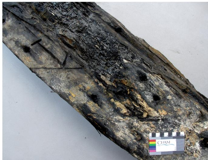
Figura 11 – Pormenor do pé da roda (ou couce de roda) do navio Boa Vista 2 com as marcas de construção.
