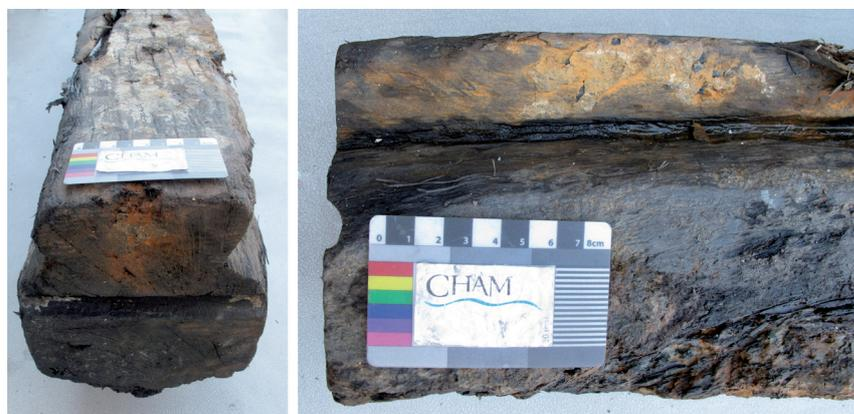
Figura 10 - Extremidade da quilha, com um entalhe de secção semicircular a toda a largura que seria preenchido por uma cavilha com função de aquastop.
