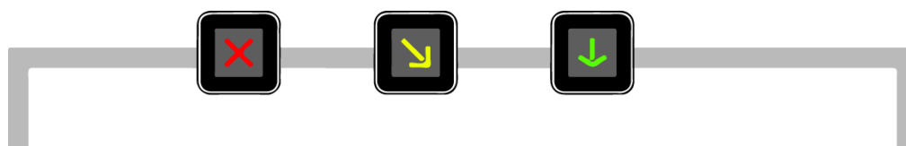
Figura 5 - Sinais luminosos de afetação de vias [30]
