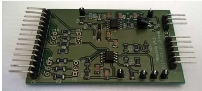
Figura 4.15: PCB final após processo de soldadura
