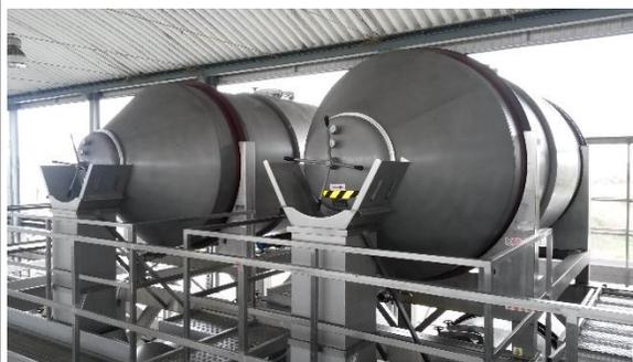
Figura 5.8 - Fotografia de Vinificadores de disposição horizontal
