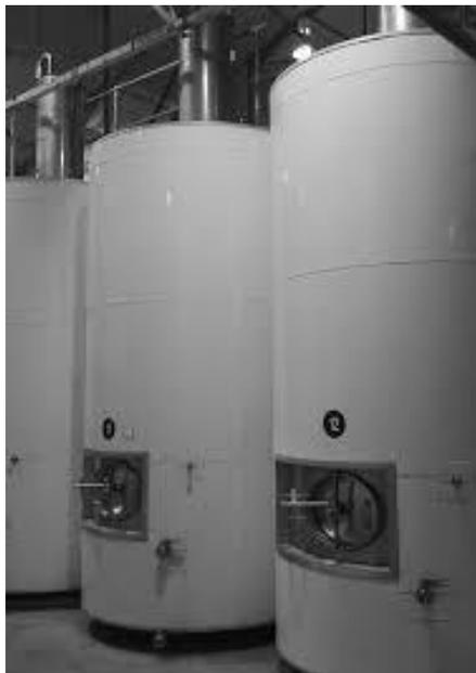
*Figura 6.1 – Cubas de vinho com isolamento e revestimento em chapa de alumínio [33]*
