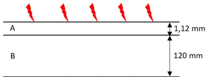
Figura 6.6 - Esquema do isolamento na chapa
