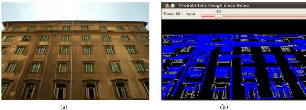
Figura 2.3 – (a) Imagem a ser processada, (b) imagem após o processo de Detecção de Linhas, retirado de [8]
