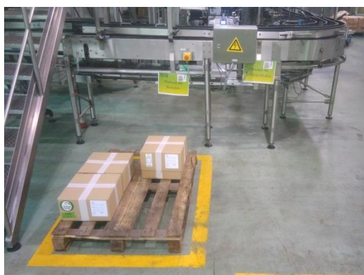
Figura 3.2 – Marcação da zona de colocação de materiais
