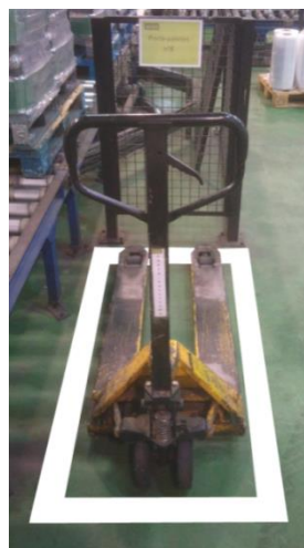
Figura 4.23 – Marcação proposta - zona de armazenagem do porta-paletes
