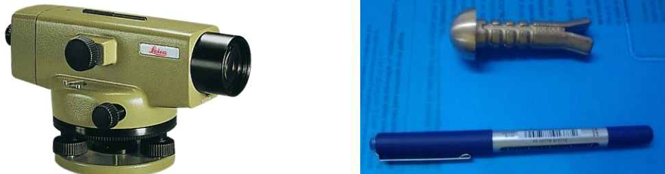
Figura 25 - Nível ótico Leica NA2 (Leica, 2017) e marca de superfície
