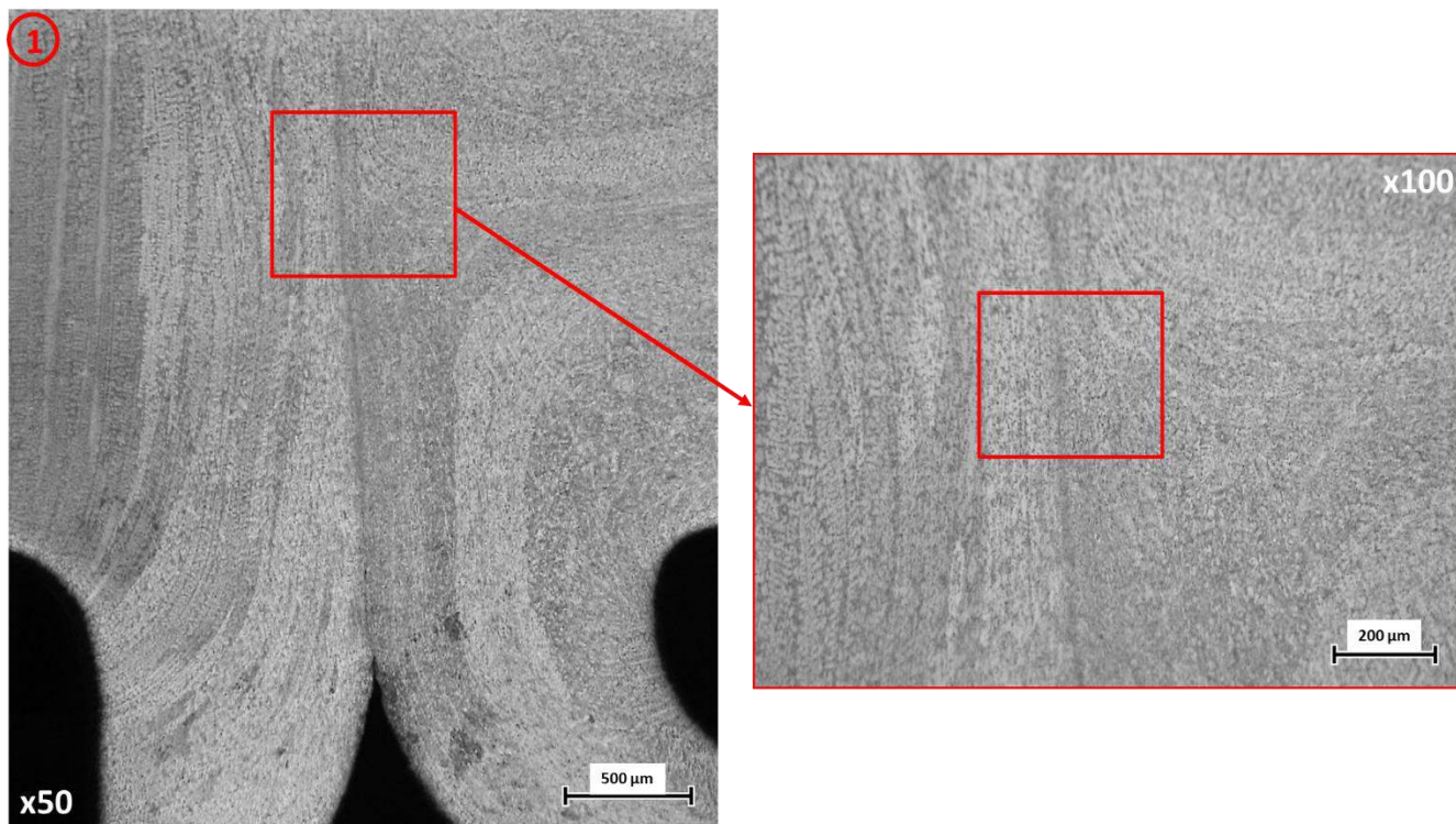
Figura 5.17 - Micrografia do provete #4B ( \theta = 180^\circ ) ampliada em 50x e 100x da zona 1.
