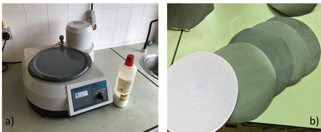
Figura A1 - Material utilizado no polimento das amostras: a) Polidora com prato giratório; b) Lixas de água com diferentes granulometrias e pano.
