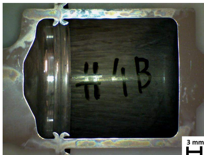
Figura 5.5 - Macrografia do provete #4B cortado e após polimento.
