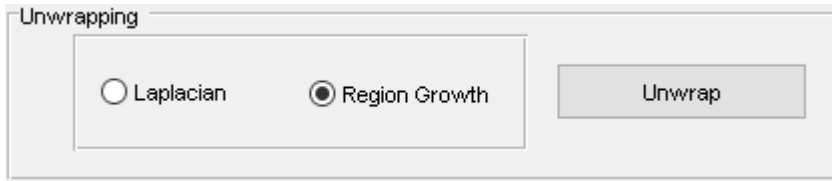
Figura 5.1-1d Opção Unwrap da fase com a possível escolha do algoritmo: Laplacian ou Region Growth
