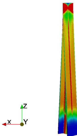
Figura 3.6: Deformada da peça quando sujeita à torção (vista no plano zx)
