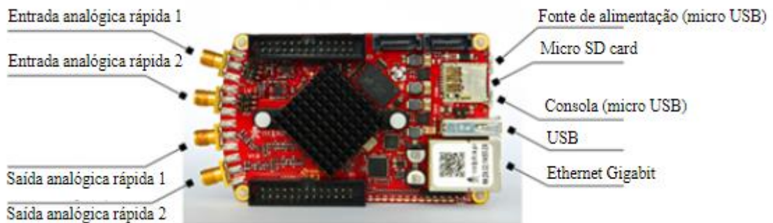
Figura 2-6 - Plataforma Red Pitaya e identificação de alguns periféricos, imagem editada de (Leban, 2014).
