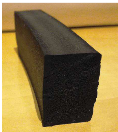
Obr. č.14: Vzorek mikroporézního EPDM profilu 20 x 30 mm
