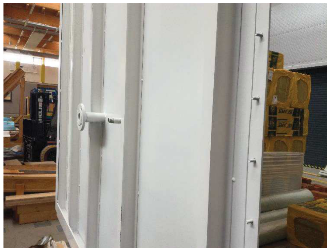
Obr. č.9: Pohled na zadní stranu komory s připravenými prostupy pro přívod či odvod vzduchu (přírubový spoj) a pro přívod vody (závitový spoj)
