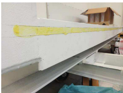
Obr. č.15:Nanesené lepidlo Alkaprén 25 Plus na zkušební komoře (vlevo) a na zdrsňeném povrchu těsnění (vpravo)
