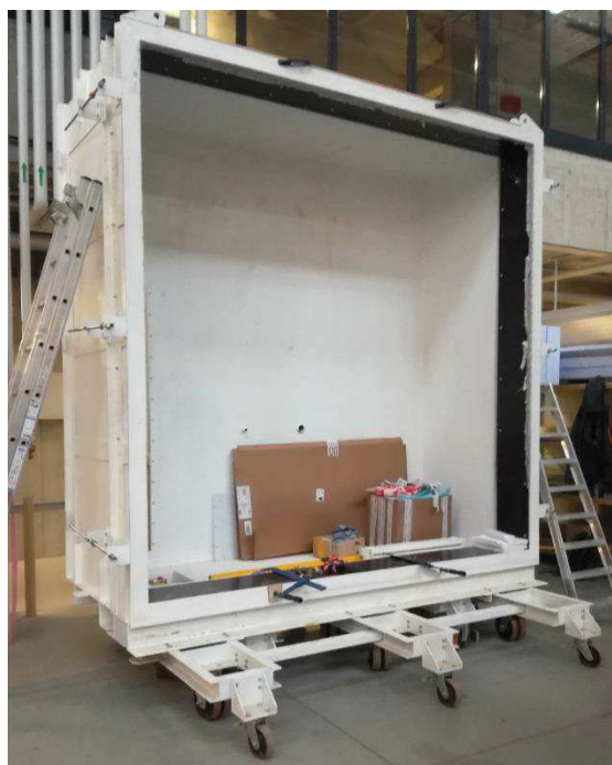
Obr. č.16: Zkušební komora s přitaženým rámem stažena závitovými tyčemi i pomocí truhlářských svěrek (zalisování těsnění na minimálně 24 hodin)
