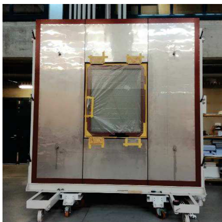
Obr. č.40: Okno přelepené vzduchotěsnou plastovou fólií, měření zbytkových toků při podtlaku
