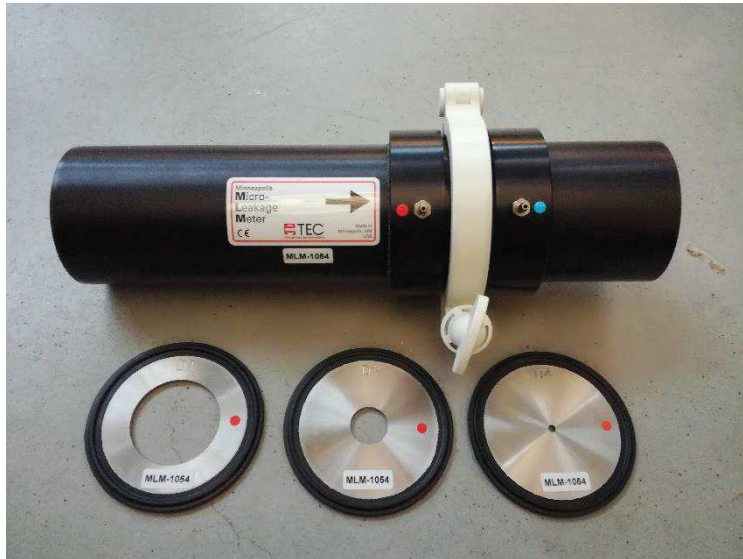
Obr. č.22: Minneapolis mikroprůtokoměr MLM s vyměnitelnými disky
