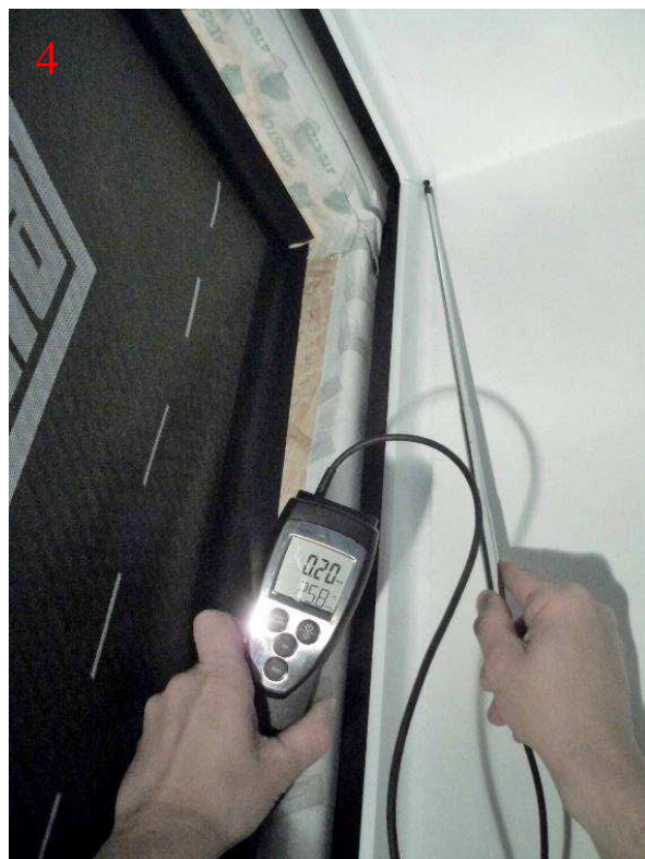
Obr. č.3: Netěsnosti v plášti zkušební komory naměřené zevnitř (vlevo netěsnost č.3; vpravo netěsnost č.4)
