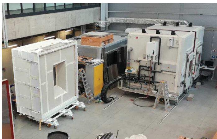
Obr. č.19: Pohled na zkušební zařízení (vlevo - komora pro měření vzduchotěsnosti a vodotěsnosti, vpravo – klimatická dvojkomora)
