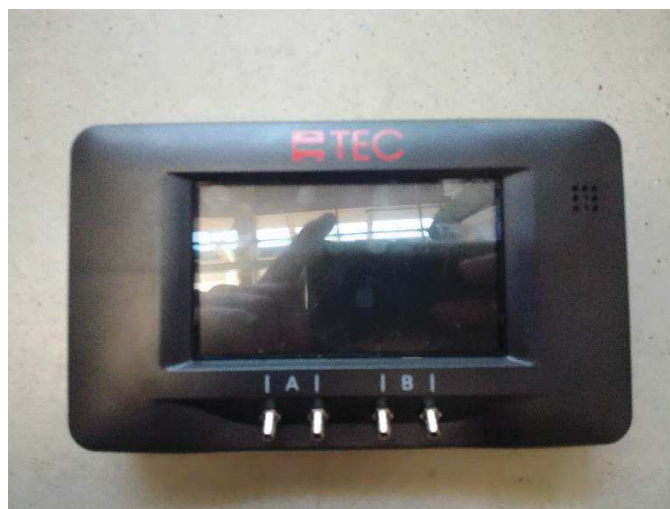
Obr. č.24: Digitální měřidlo tlaku Minneapolis DG-1000
