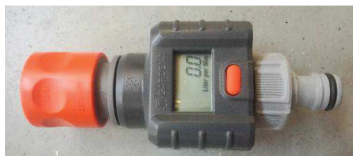
Obr. č.30: Průtokoměr Gardena typ 8188
