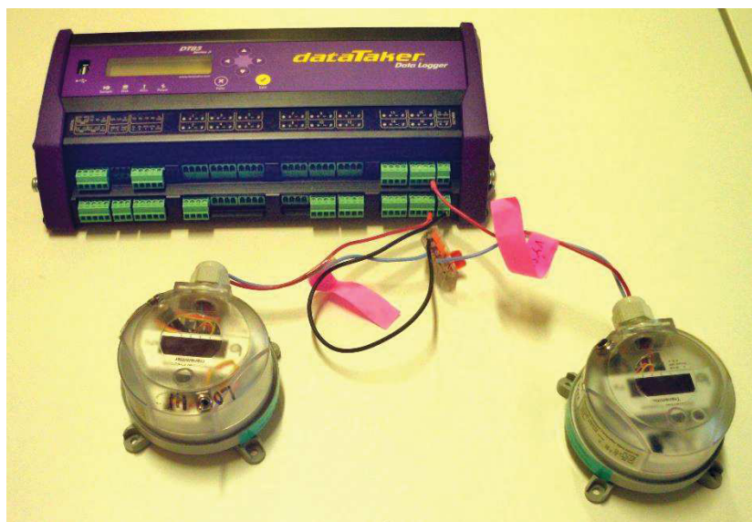
Obr. č.25: Diferenční manometry Beck 984 se zapisovačem dat DataTaker
