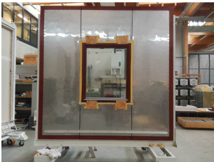
Obr. č.42: Pohled na osazené zkušební okno ze strany exteriéru
