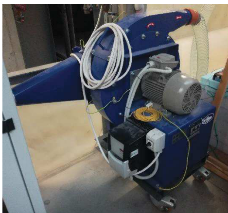
Obr. č.20: Regulovatelný ventilátor s frekvenčním měničem a regulací měniče
