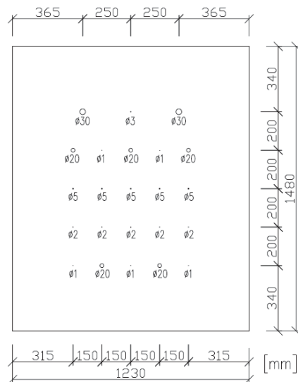
Obr. č.46: Návrh rozmístění a velikosti otvorů (vlevo) a osazená deska s otvory (vpravo)
