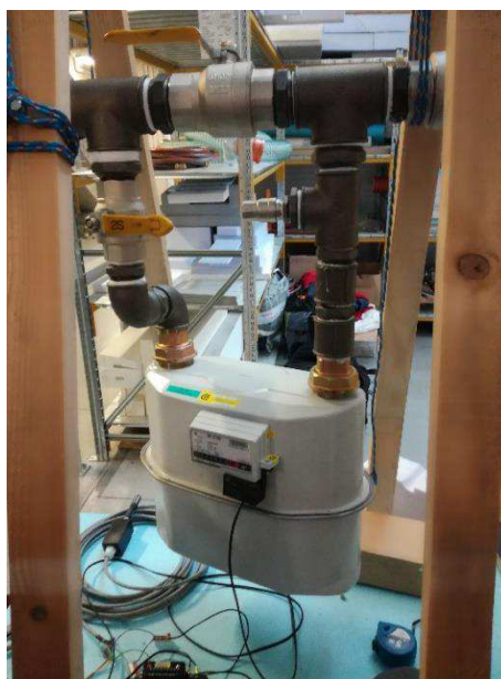
Obr. č.3: Membránový plynoměr zapojený bypassem, na obrázku je vidět stav tlakování komory (horní kohout je otevřený, kohout směrem do bypassu uzavřený)
