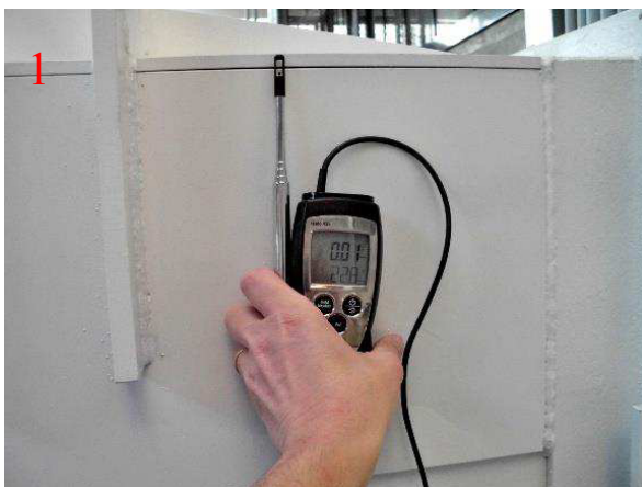
Obr. č.2: Netěsnosti v plášti zkušební komory naměřené zvenku (vlevo netěsnost č.1; vpravo netěsnost č.2)
