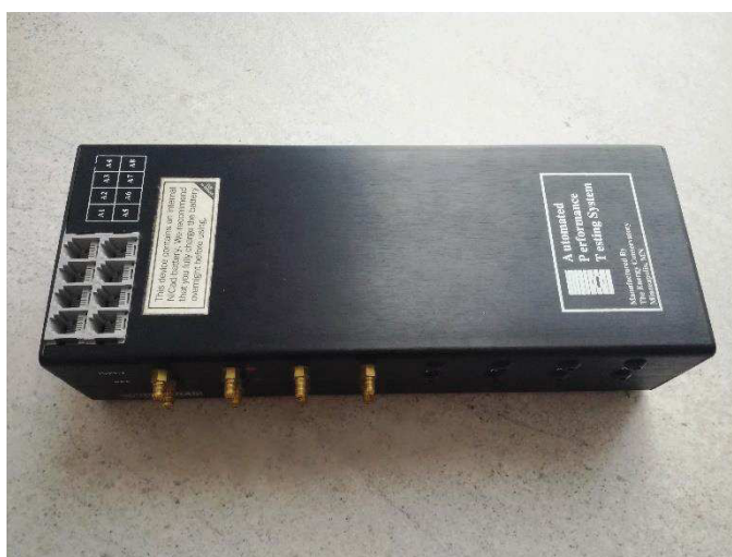
Obr. č.26: Měřidlo tlakových rozdílů Minneapolis APT-8
