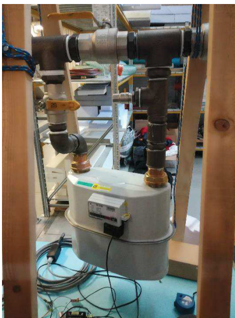
Obr. č.21: Membránový plynoměr BK – G10M s nízkofrekvenčním snímačem IN-Z61
