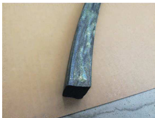
Obr. č.15:Nanesené lepidlo Alkaprén 25 Plus na zkušební komoře (vlevo) a na zdrsňeném povrchu těsnění (vpravo)
