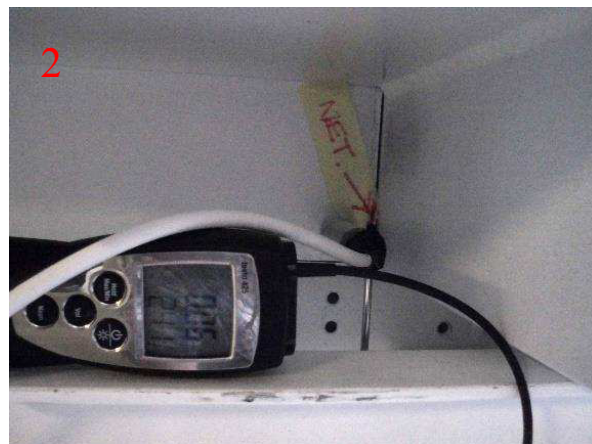
Obr. č.2: Netěsnosti v plášti zkušební komory naměřené zvenku (vlevo netěsnost č.1; vpravo netěsnost č.2)
