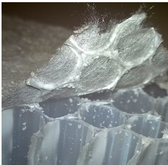
Obr. 9: Detail struktury voštiny s částečně odříznutým potahem
