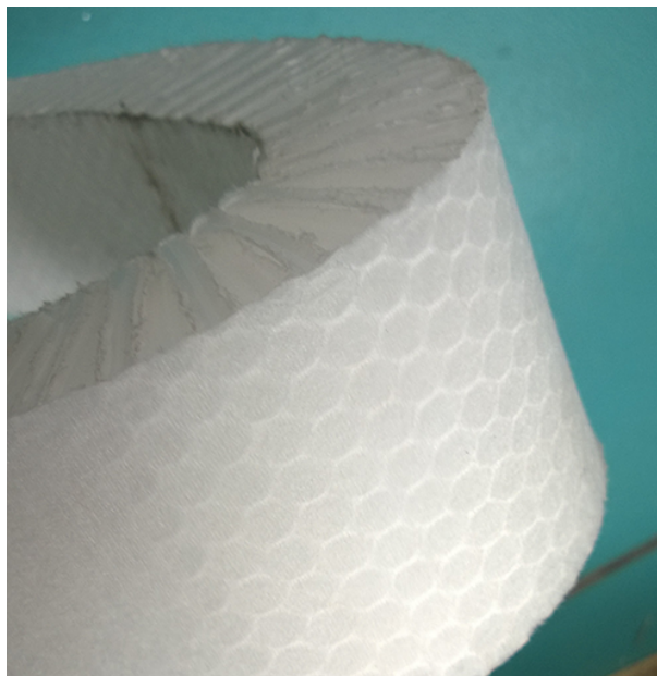
Obr. 30: Neporušená struktura buněk při velké deformaci
