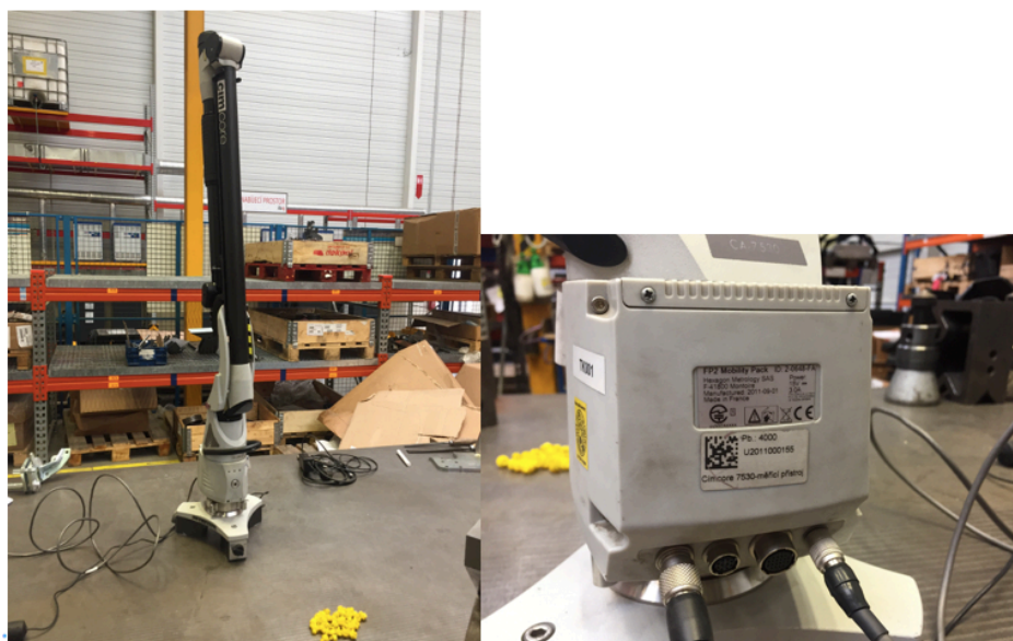
Obr. 65. Cim core měřicí rameno (vlevo) a detailní štítek měřícího zařízení (vpravo)
