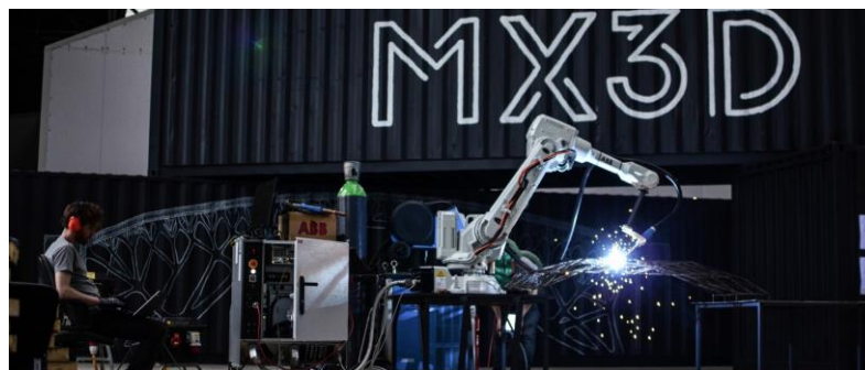
Obrázek 18: využití robotické ruky v 3D tisku
