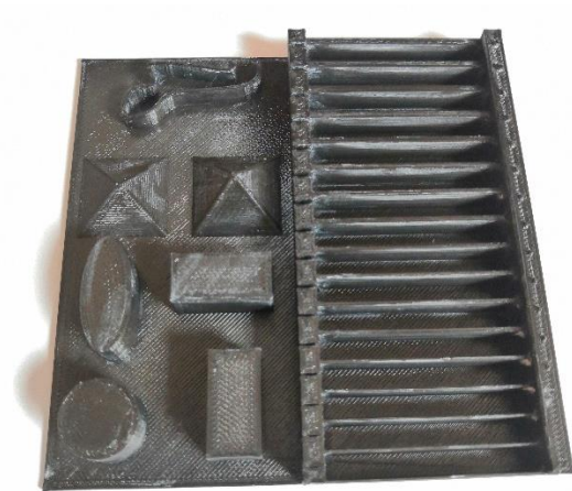
Obrázek 56: vytištěný artefakt pro test rozměrových tolerancí
