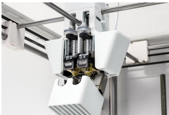
Obrázek 37: dvoutryskové provedení tiskové hlavy (Ultimaker 3)
