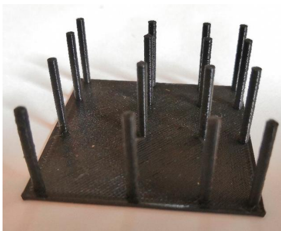
Obrázek 55: vytištěný artefakt pro test vzniku plastových otřepů
