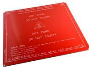
Obrázek 26: tisková podložka realizována deskou plošných spojů
