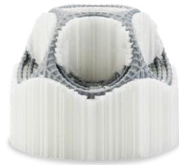
Obrázek 41: ukázka tisku rozpustitelných podpor z materiálu PVA
