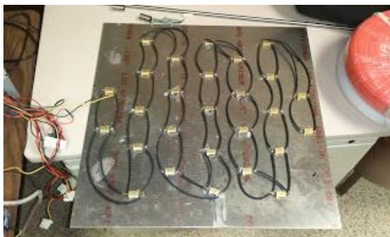
Obrázek 27: tisková podložka realizována rezistory
