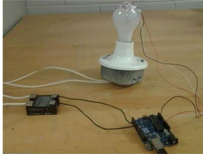
**Figura 4.** Esquema de conexión foco, Relay y Arduino.
