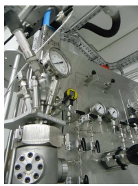
Réacteur agité pour la synthèse d'hydrates
