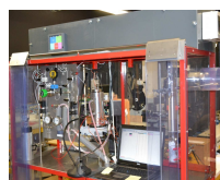
Couplage réacteur – caméra CCD et spectromètre Raman (JOBIN YVON T64000)
