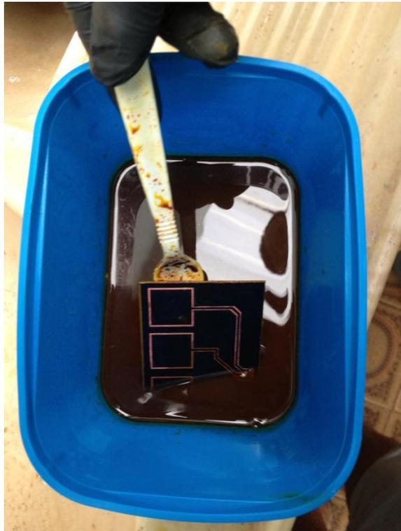
Figura 3.6 - Processo de corrosão do sensor capacitivo.
