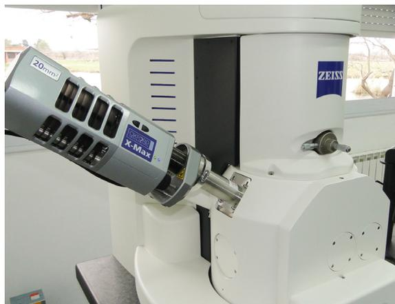
Microscopio electrónico de barrido
