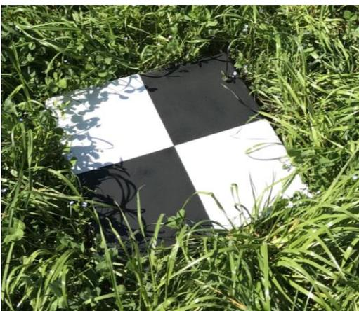
Abbildung 5: GCP Betongartenplatte angemalt 60 cm x 60 cm
