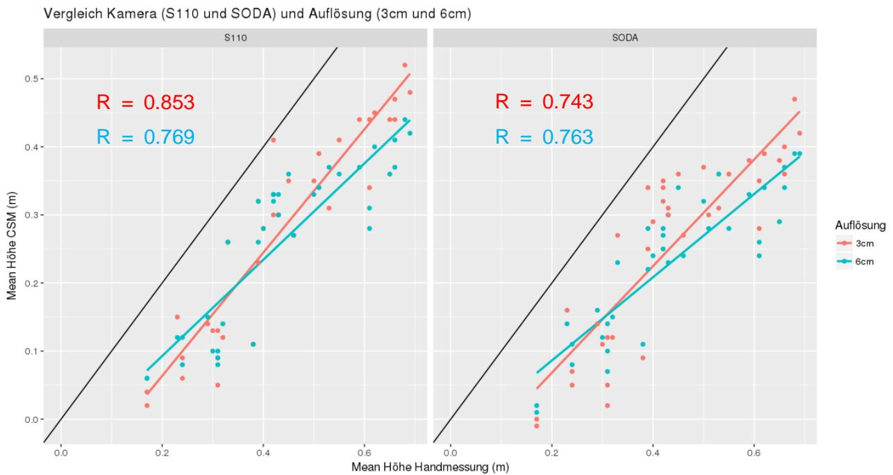
Abbildung 29: Vergleich der Mean Höhe CSM und Mean Höhe Handmessung der beiden Kameras CanonPowerShotS110 (links) und SODA 10.6 (rechts). Die zwei Farben zeigen die unterschiedlichen Auflösungen 3cm und 6cm.
