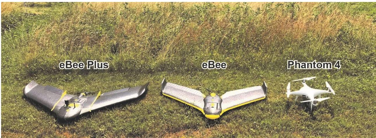
Abbildung 10: Die verwendeten Drohnen: eBee und eBee Plus von SenseFly, Phantom 4 von DJI
