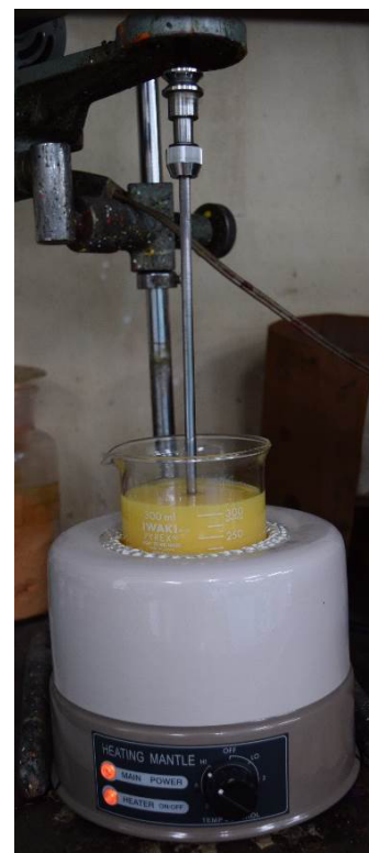
図3 マントルヒーターを用いてブラックオイルを製作している様子
