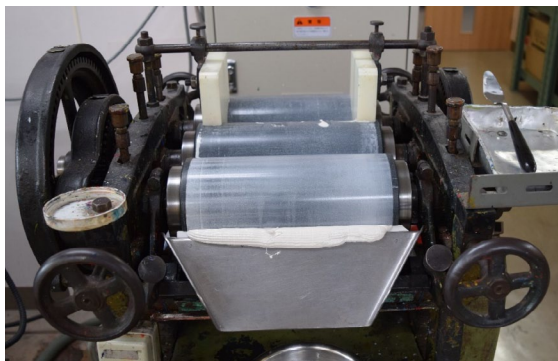
図4 鉛白の顔料とオイルをロールミルにかけている様子
