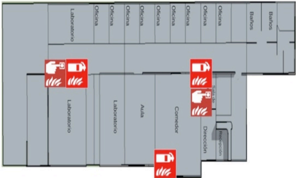
Figura V- 24. Ubicación de las Estaciones manuales de alarma contra incendios en el edificio I4
