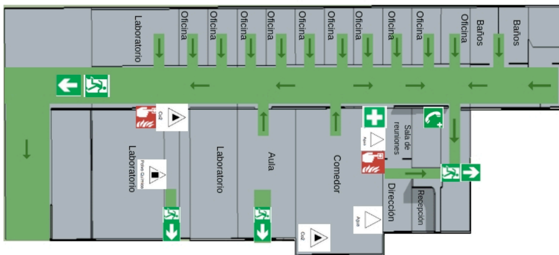
Figura IV -11. Distribución de los extintores del edificio I4
