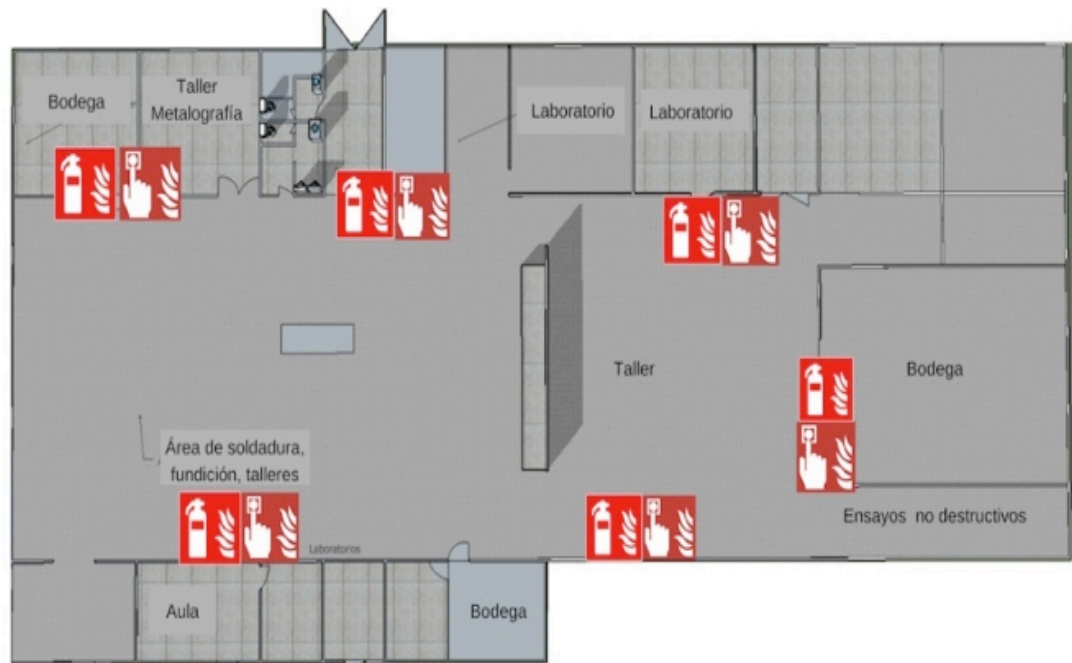
Figura V -22. Ubicación de las estaciones manuales del sistema de incendio en el primer piso del edificio I1
