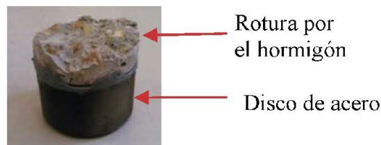
Fig. 7. Rotura del ensayo Pull Off
