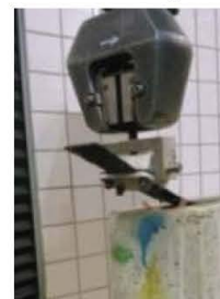
Fig. 1. Esquema y ensayo experimental Lap Peeling
