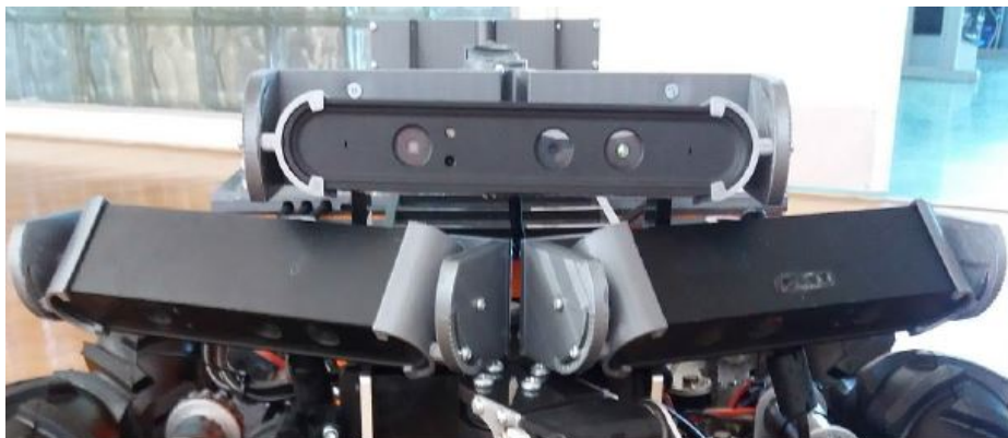
Figura 5. 17 Representación del posicionamiento de las camaras ASUS Xtion en la plataforma SIAR
