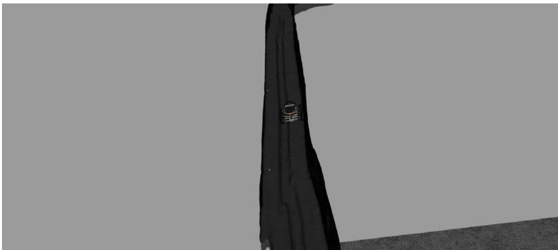
Figura 6. 54 Desplazamiento del robot SIAR por el canal del alcantarillado con respuesta estable ante el desnivel de superficies
