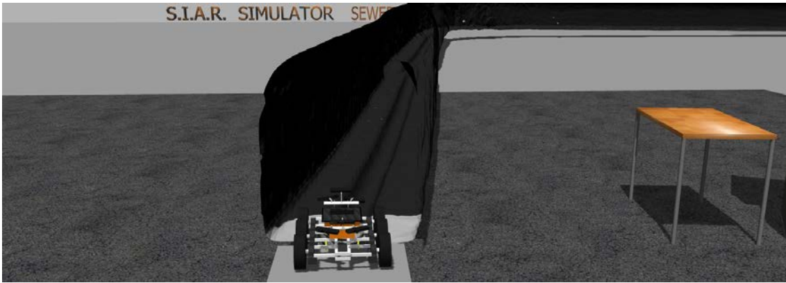
Figura 6. 38 Visualización del robot SIAR simulado al alcantarillado con respuesta estable a la irregularidad de nivel de la entrada
