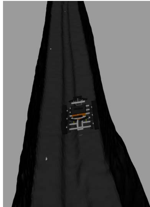
Figura 6. 52 Robot SIAR simulado en el interior del canal del alcantarillado
