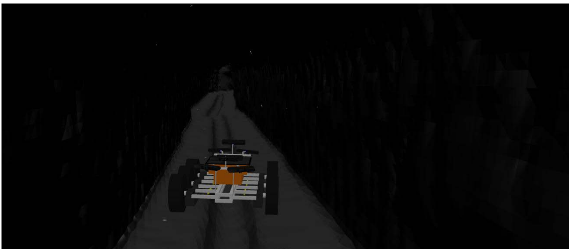
Figura 5. 25 Entorno generado a partir de la modificación del mapa del alcantarillado e incorporándolo al archivo siar_model.launch” de simulación del modelo en Gazebo
