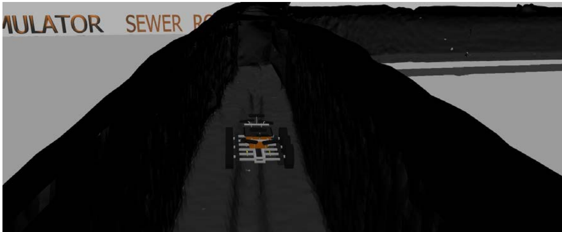
Figura 6. 55 Robot SIAR posicionado nuevamente en alcantarillado fuera del canal gracias a la utilización de las herramientas del GUI de Gazebo
