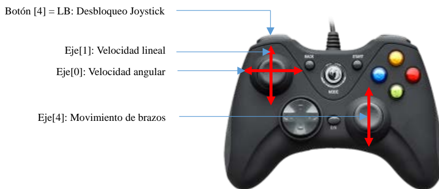
Figura 5. 27. Distribuciones de ejes y botones utilizados en el joystick nacon controller GC-100XF para controlar manualmente la simulación del modelo en Gazebo.
