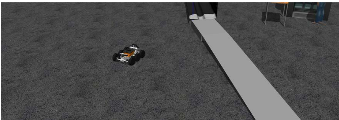
Figura 6. 30 Visualización robot SIAR simulado desplazandose sobre asfalto con respuesta estable a aceleración y tracción.
