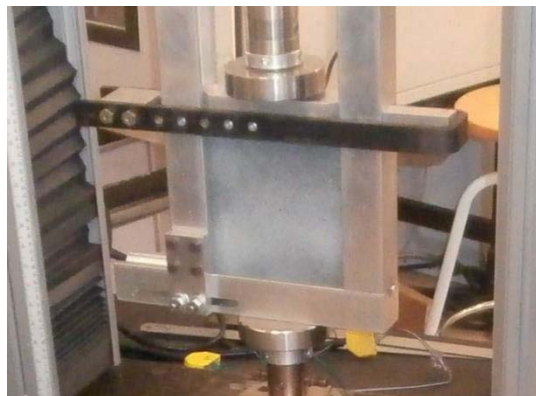
Fig. 2. Dispositivo y probeta montados en la máquina de ensayos.
