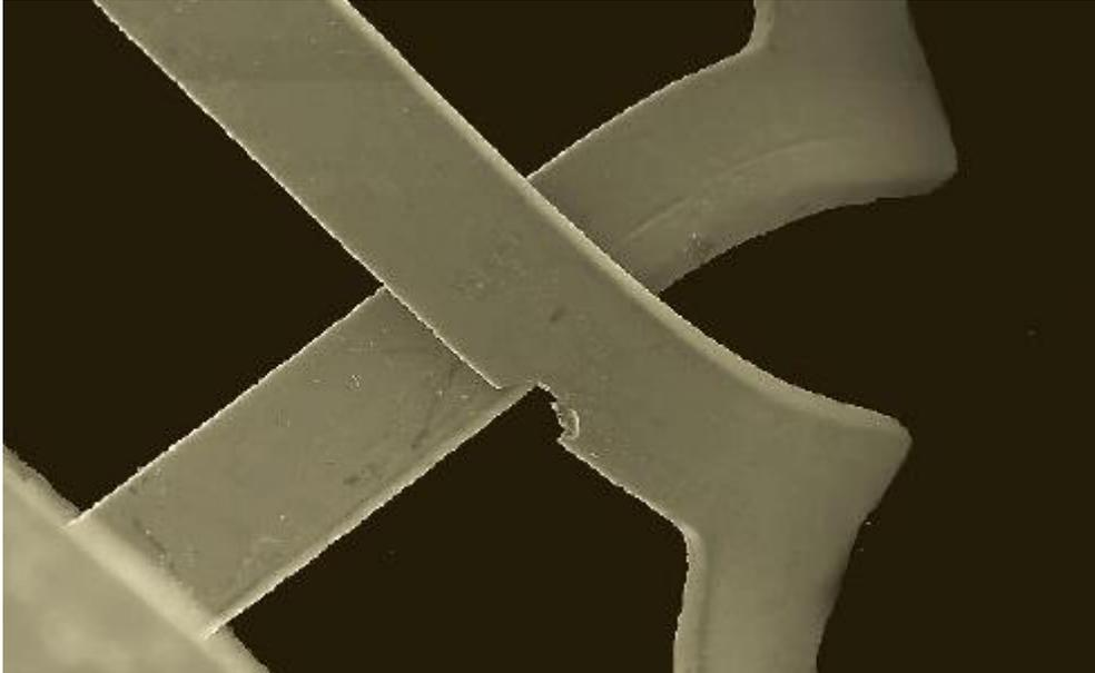
**Figura 9.** Corrosión localizada en un ‘*Stent*’ de Nitinol. Tomado de [25]
