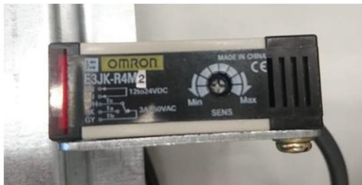
Figura 10: Sensor fotoeléctrico E3JK-R4M de marca OMRON
