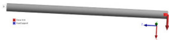
Рисунок 1. Прикладена сила А і закріплення В
