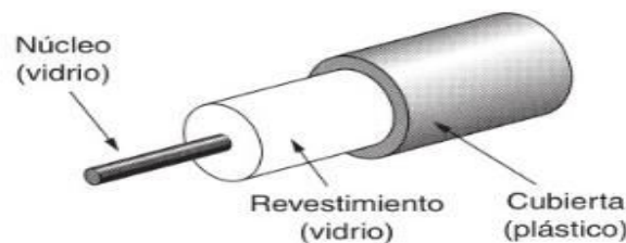
Fig. 2. 3. Secciones de un cable de fibra óptica
