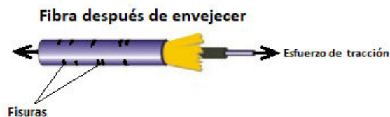
Fig. 2.17 Fisuras en un cable de fibra óptica
