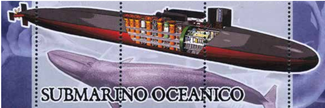
KUVA 119 • Näkymä sukellusveneen pystysiiloista, joissa voi olla SLBM-, SLGM ja/tai SAM tyyppisiä ohjuksia.
