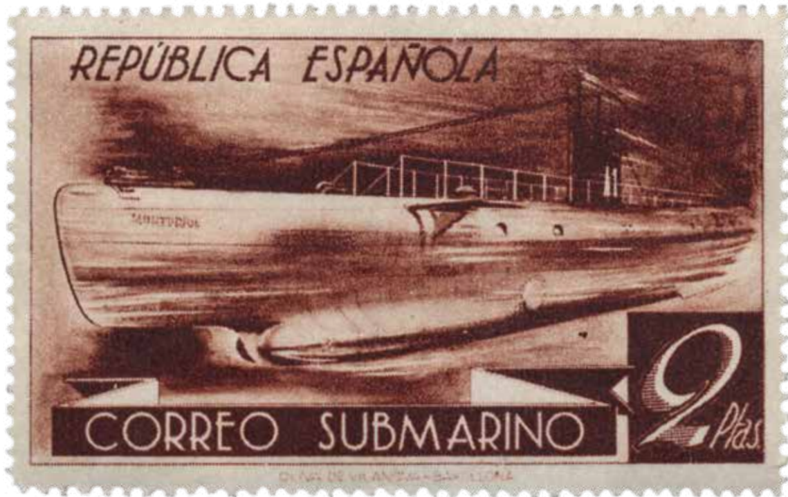
KUVA 46 • A-luokka, Espanja, 1917. Kaiteet hidastamassa nopeutta veden alla.
