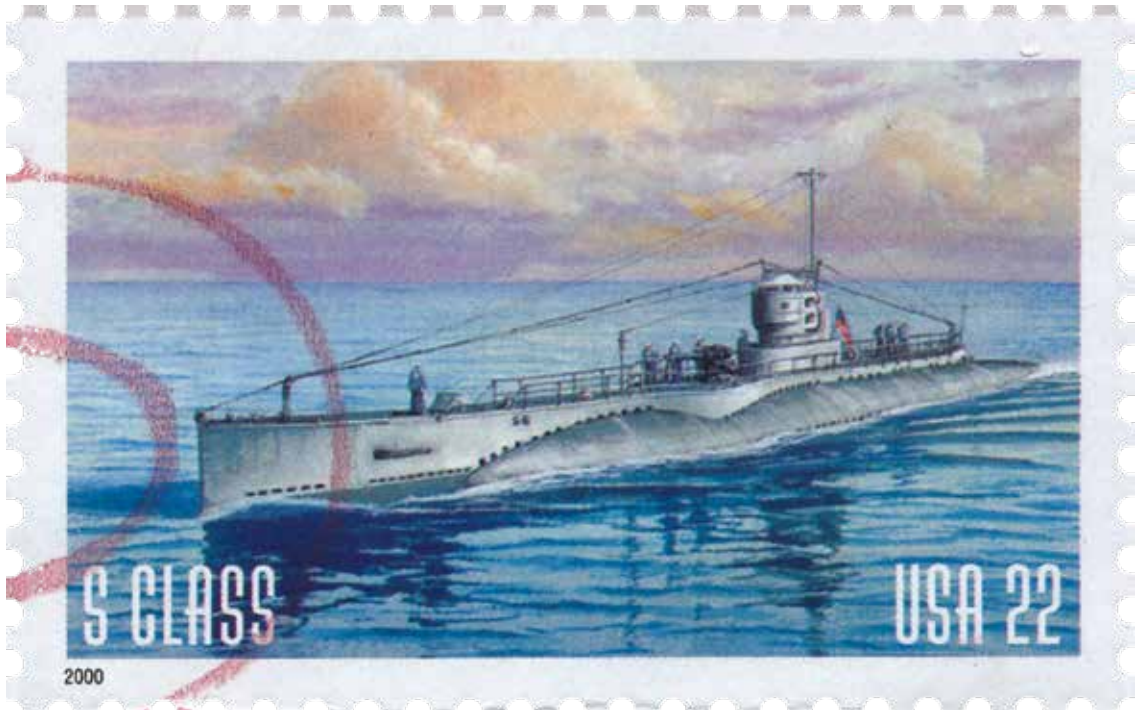
KUVA 44 • Erityisesti 'pintakulkuun' (huom! kaiteet) tarkoitettu S-luokka, Yhdysvallat, 1919. Epäonnistunut konstruktio.
