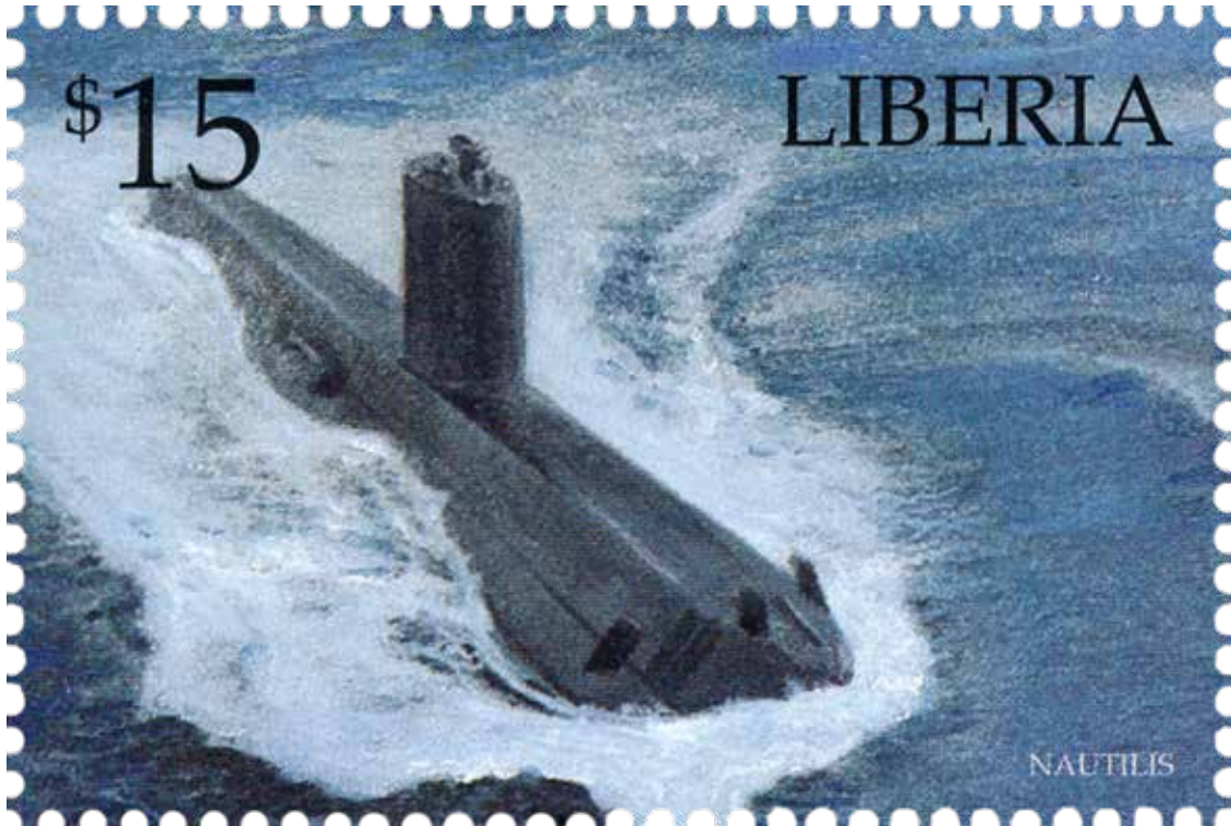
KUVA 95 • Nautilus, Yhdysvallat, 1955. Ensimmäinen ydinreaktorilla toiminut sukellusvene.
