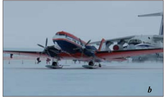
Abb. 5.1-2: a) Station Novo Airbase (Russland): Landung einer IL-76TD auf der für große Flugzeuge mit Radfahrwerk präparierten, ca. 3.000 m langen Landebahn (Foto: Alexey Nagaev, Moskau). b) Station Troll: Umsteigen von der IL-76TD für den Weiterflug mit einer BT-67 (Polar 6), die mit einem kombinierten Ski- und Radfahrwerk auf den Schneepisten der Dromlan-Stationen landen kann (Foto: H. Gernandt, AWI).
